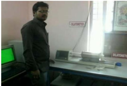
Fig. 2.1: NETZSCH Dilatometer 420PC
